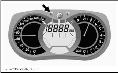
Alors que l'affichage clignote, appuyer sur le bouton de réglage (S) et le tenir dans les 5 prochaines secondes pour remettre à zéro.
