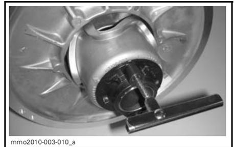
**DISPOSITIF DE RÉGLAGE À BAGUE**
