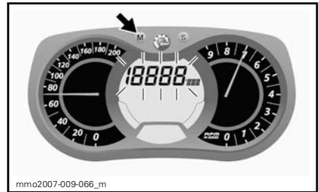
Alors que l'affichage clignote, appuyer sur le bouton de réglage (S) pour sélectionner le mode vitesse de pointe (TOP\_SPD).
