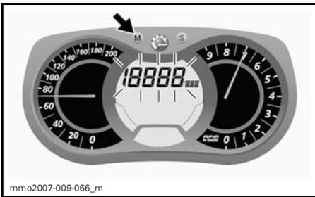
Appuyer sur le bouton de RÉGLAGE (S) et le tenir 5 secondes pour le remettre à zéro.
