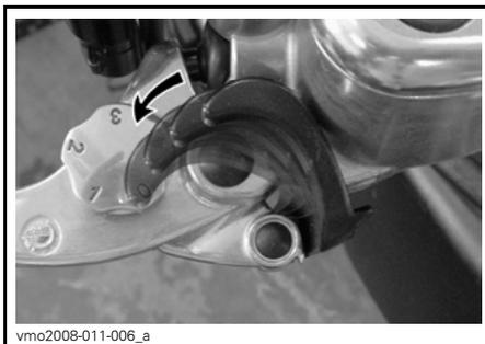
Mantenga presionada la palanca del embrague.
