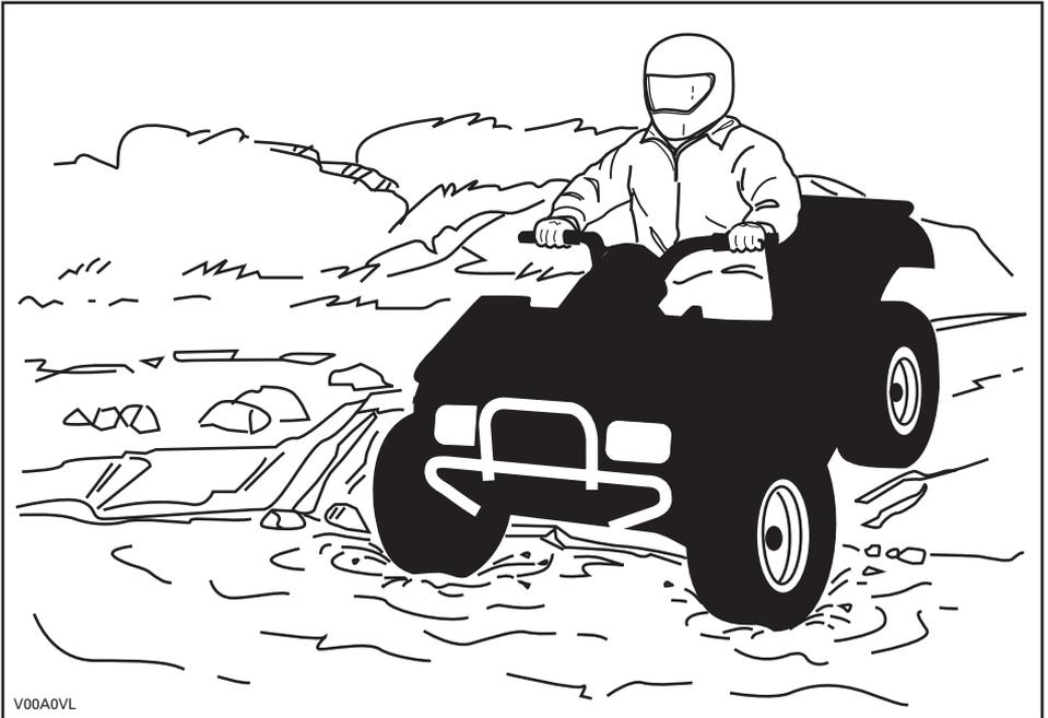
El agua afecta a la capacidad de frenado del vehículo. Asegúrese de que se sequen los frenos; para ello, acciónelos varias veces después de salir del agua con el vehículo.
