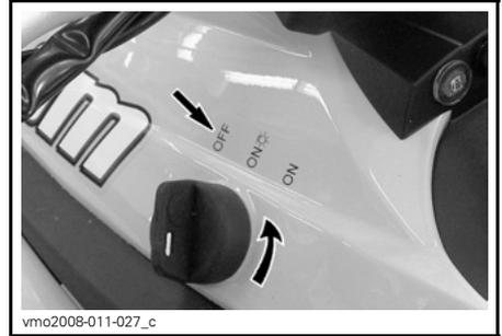
**Nota:** En el modelo X xc, si se saca la pinza del cable de seguridad del interruptor de paro de seguridad, también se detendrá el motor.
