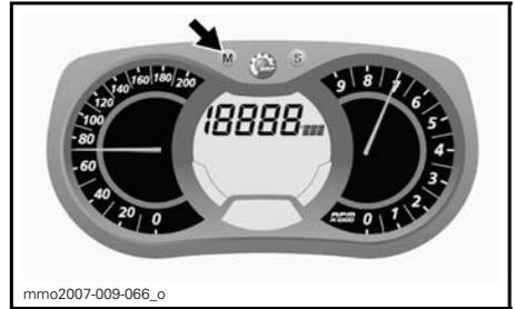
**B) Tachymètre (RPM)**
