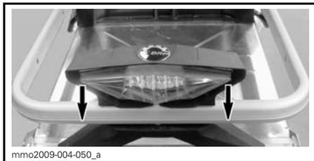
**AVIS** Les goupilles de retenue en plastique peuvent se briser si on force le feu arrière latéralement. Éviter de faire un mouvement latéral lorsqu'on retire le feu arrière.
