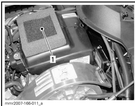
1. Filtre à air sur le dessus du silencieux d'admission d'air
