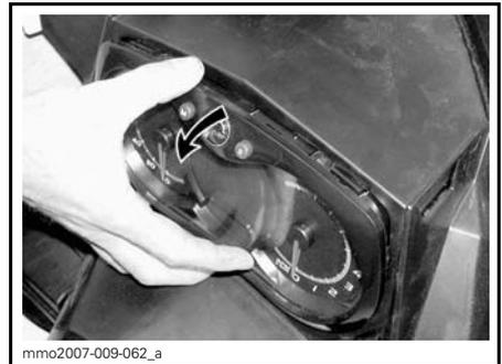
3. Débrancher le connecteur de l'ampoule grillée. Enlever le soufflet de caoutchouc.
