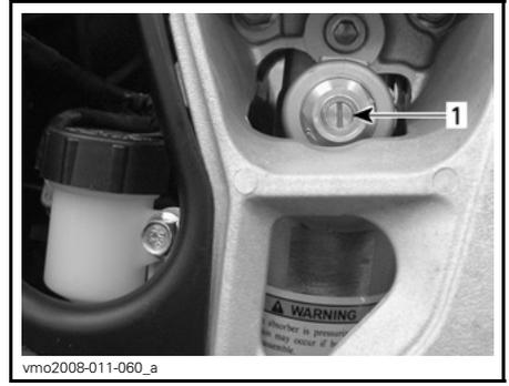
1. Ajustador de compresión (destornillador plano)
