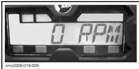
3. Pulse el botón selector y MANTÉNGALO PULSADO durante 2 segundos. Con esta acción cambiará el modo de visualización al de velocidad, r.p.m. o combinado.
