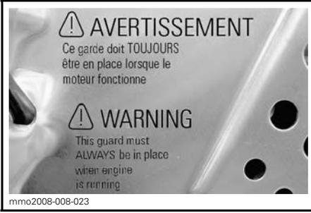
LABEL 14 - ON BRAKE DISC GUARD (BARE METAL TUNNEL)
