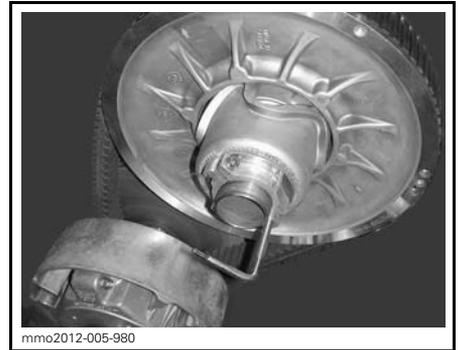
**PULLEY EXPANDER INSTALLED ON ADJUSTER HUB**
