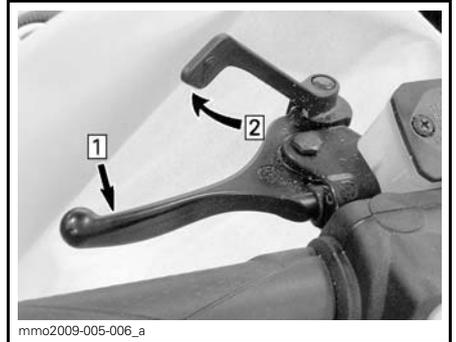
**TYPIQUE — POUR VERROUILLER LE MÉCANISME**
