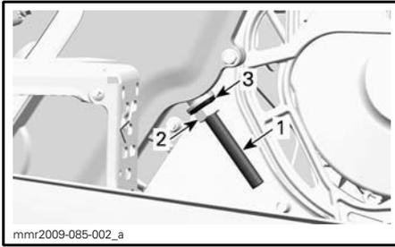
1. Vis de réglage du tendeur de chaîne
