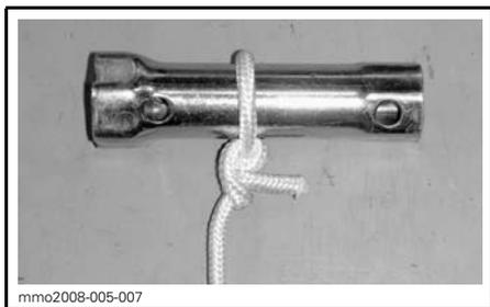
Attacher l'autre extrémité du câble d'urgence à l'agrafe de démarrage fournie dans le nécessaire d'outils.
