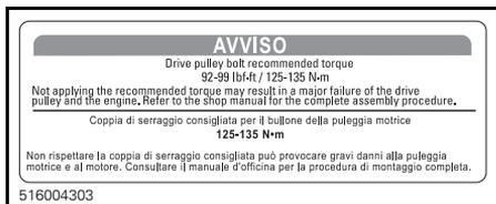
SULLA PROTEZIONE DELLA CINGHIA DI TRASMISSIONE
