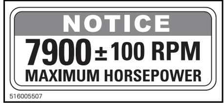
LABEL 4- NEAR DRIVE PULLEY - 800R E-TEC
