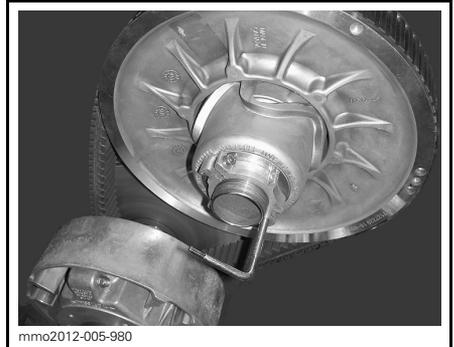
**PULLEY EXPANDER INSTALLED ON ADJUSTER HUB**
