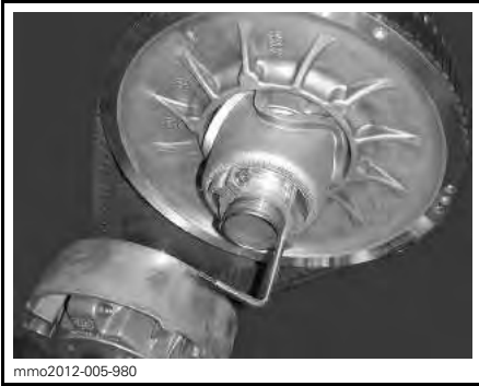
OUTIL D'ÉCARTEMENT DE POULIE MENÉE INSTALLÉ SUR L'ANNEAU DE RÉGLAGE
