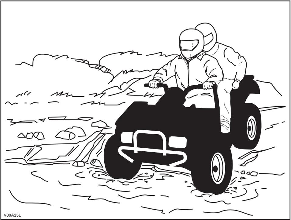
El agua afecta a la capacidad de frenado del vehículo. Asegúrese de que se sequen los frenos; para ello, acciónelos varias veces después de salir del agua con el vehículo. La distancia de frenado puede verse afectada si se lleva un pasajero. Reduzca prudentemente la velocidad cuando lleve un pasajero. Tenga en cuenta la necesidad de una mayor distancia para el frenado.
