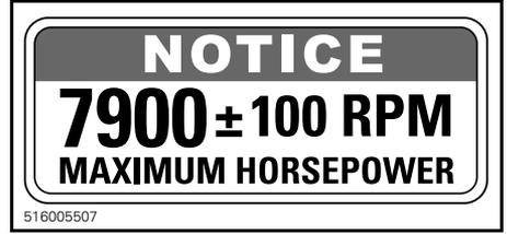
LABEL 4 - NEAR DRIVE PULLEY - 800R E-TEC
