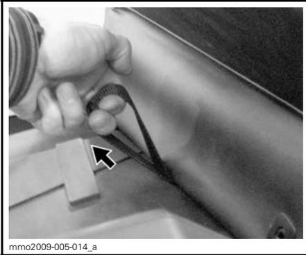
3. Soulever l'arrière du siège et le tirer délicatement vers l'arrière juste assez pour accéder au connecteur d'accessoires.
