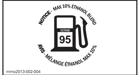
**SUR LE BOUCHON DU RÉSERVOIR D'ESSENCE - MOTEURS E-TEC - DANS LES PAYS OÙ ON UTILISE LES INDICES D'OCTANE RON**
