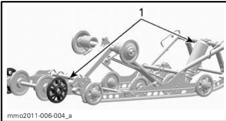
1. Raccords de graissage
