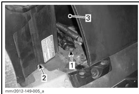
1. Fusible de système de charge (20 A)
