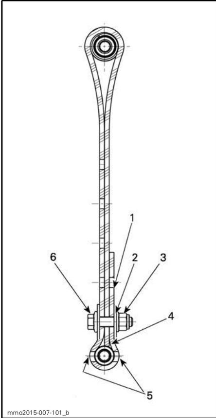
**POSITION 2 DE LA COURROIE D'ARRÊT (2<sup>E</sup> ORIFICE)**
