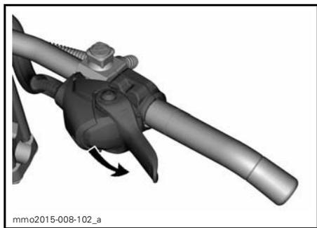
**POSITION D'ACTIVATION AVEC LE POUCE: POUSSER VERS LE BAS POUR TOURNER LE BOÎTIER DE COMMANDE DES GAZ**
