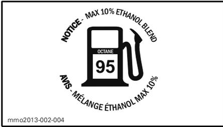
**SUR LE BOUCHON DU RÉSERVOIR
