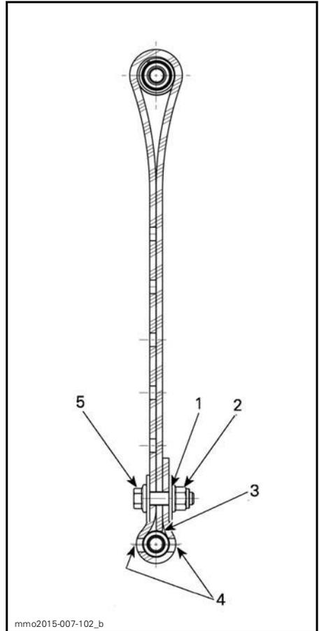
**POSITION 1 DE LA COURROIE D'ARRÊT (1<sup>ER</sup> ORIFICE, COURROIE LA PLUS LONGUE)**
