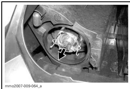
TIRER SUR L'AMPOULE ET LA REMPLACER
