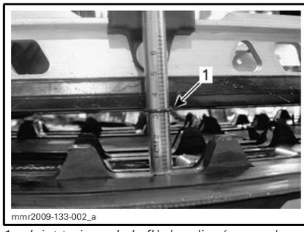
1. Joint torique de la flèche alignée avec la glissière
