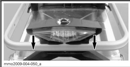
**AVVISO** Non estrarre eccessivamente l'alloggiamento del fanalino per evitare di danneggiare il cablaggio.
