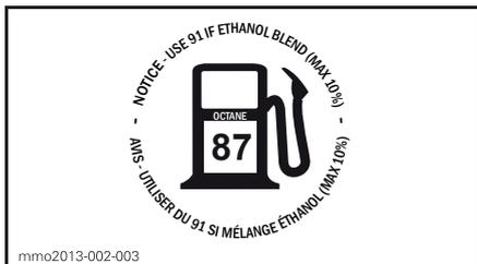
НА КРЫШКЕ ТОПЛИВНОГО БАКА - МОДЕЛИ 550 F, 600 АСЕ И 900 АСЕ (В СТРАНАХ, ИСПОЛЬЗУЮЩИХ АКІ ДЛЯ ОБОЗНАЧЕНИЯ ОКТАНОВОГО ЧИСЛА)
