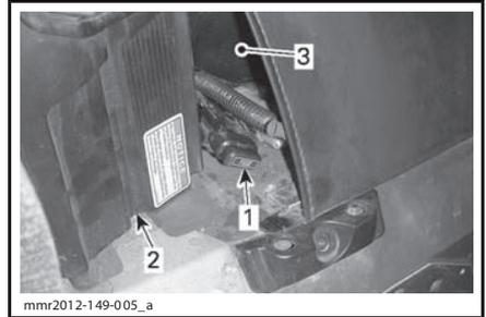
1. Предохранитель системы зарядки (20А)
