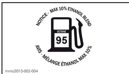
НА КРЫШКЕ ТОПЛИВНОГО БАКА - МОДЕЛИ 600 НО E-ТЕС (В СТРАНАХ, ИСПОЛЬЗУЮЩИХ ОЧИ (RON) ДЛЯ ОБОЗНАЧЕНИЯ ОКТАНОВОГО ЧИСЛА)
