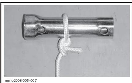
3. Другой конец шнура подсоедините к пусковому зажиму, входящему в возимый комплект инструментов.
