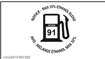
НА КРЫШКЕ ТОПЛИВНОГО БАКА - МОДЕЛИ 600 НО E-ТЕС (В СТРАНАХ, ИСПОЛЬЗУЮЩИХ АКІ ДЛЯ ОБОЗНАЧЕНИЯ ОКТАНОВОГО ЧИСЛА)
