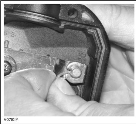
Seitliche Abdeckung vom Drosselklappengehäuse entfernen.
