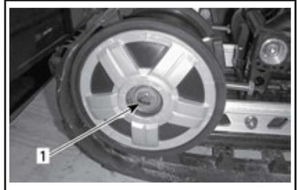
1. vis de retenue de la roue intermédiaire arrière
