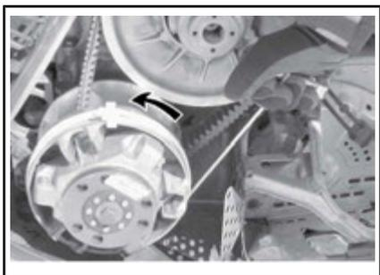
Tirez sur la corde d'un mouvement ferme et sec, de sorte que la corde se libère de la poulie d'entraînement.
