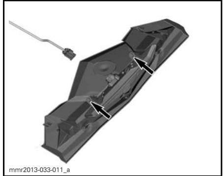
**RETAINING BOLTS SECURING TAILLIGHT TO TAILLIGHT SUPPORT**
