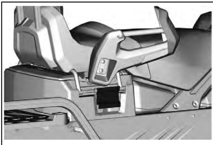
2. Soulevez le siège pour débrancher le connecteur électrique.
