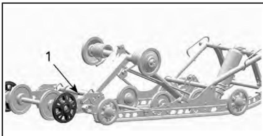
1. Raccords de graissage
