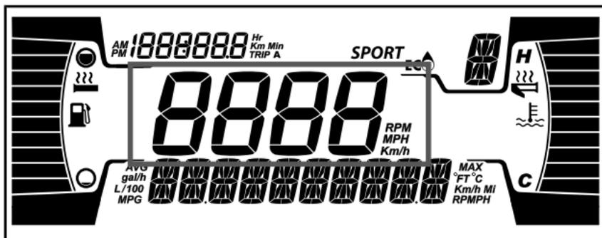
Indique le régime (tr/min) ou la vitesse du véhicule en km/h ou en mi/h.
