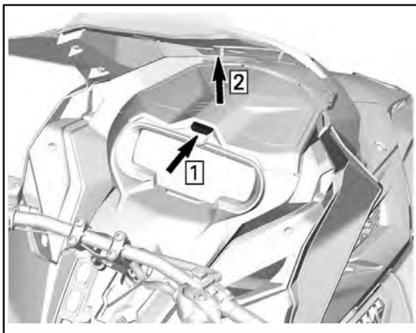
2. Retirez les vis de fixation du support de la jauge
