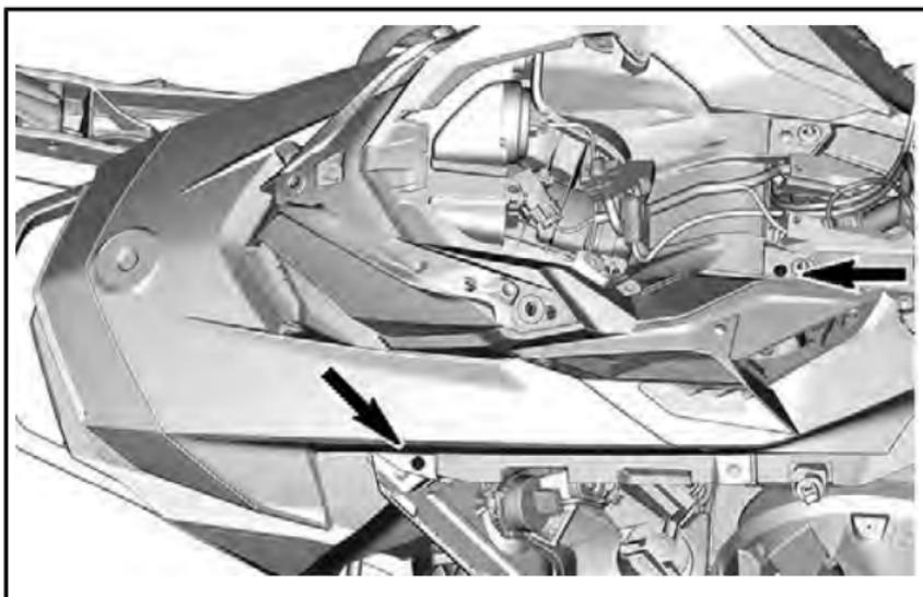
9. Libérez les crochets arrière du module de carrosserie supérieur des fentes dans la console.
