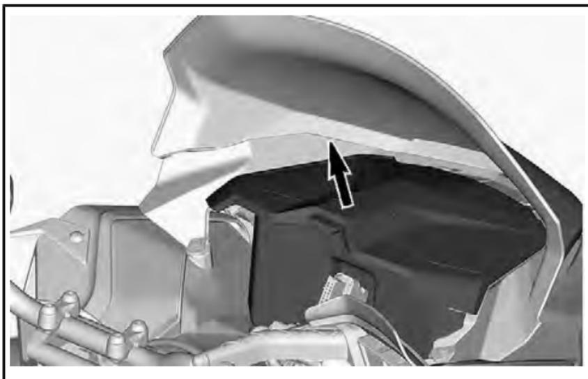
6. Déconnectez MAPTS et le connecteur d'ampoule.
