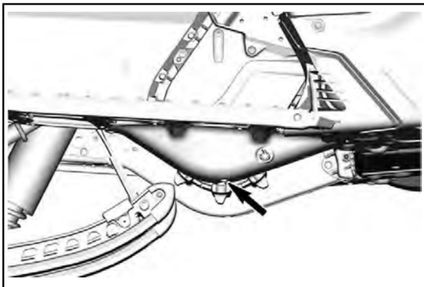
1. *Trou d'accès du bouchon de remplissage*
