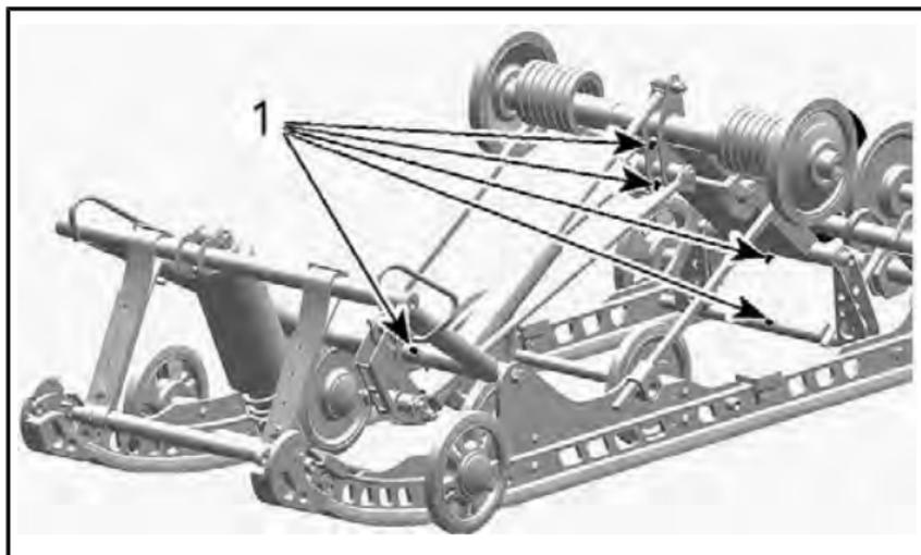
1. Raccords de graissage
