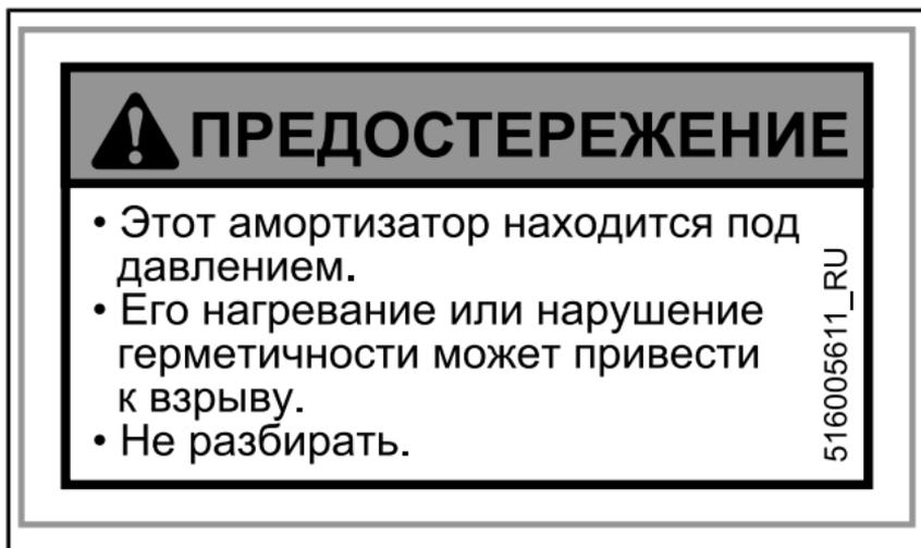
НАКЛЕЙКА 11 — НА ГАЗОВОМ АМОРТИЗАТОРЕ
