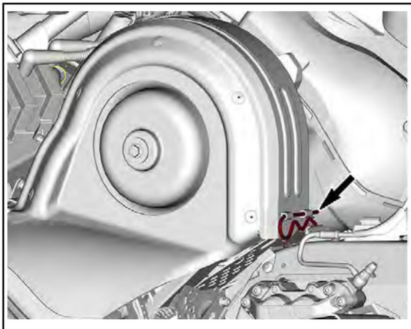
Поднимите кожу за его заднюю часть и извлеките из передних выступов.
