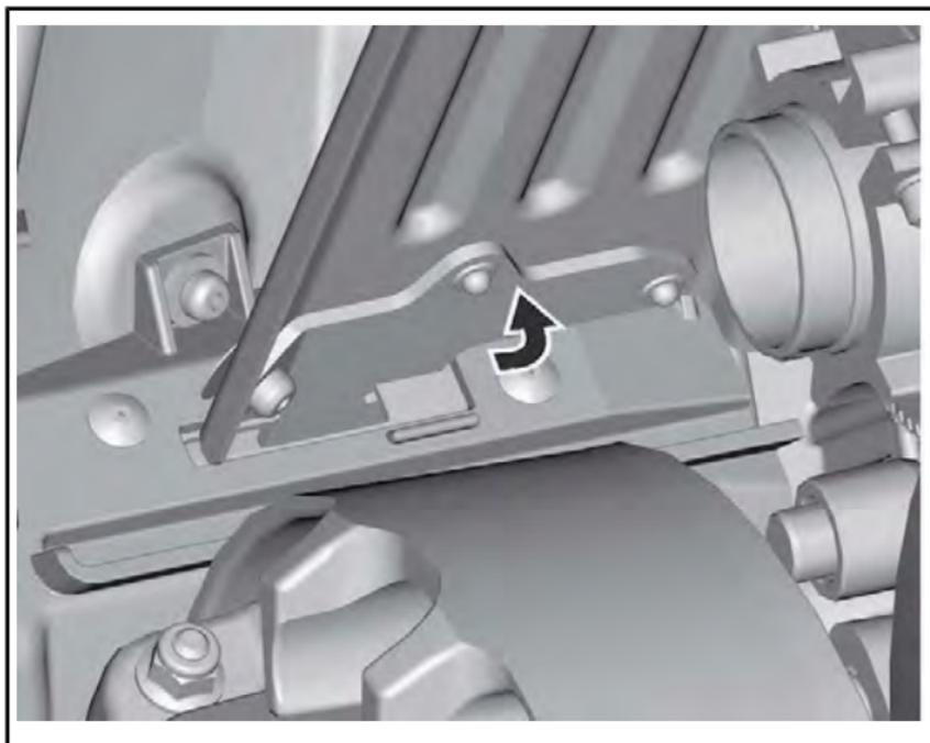
Установите заднюю часть кожуха на держатель и закрепите его с помощью проволочного фиксатора.
