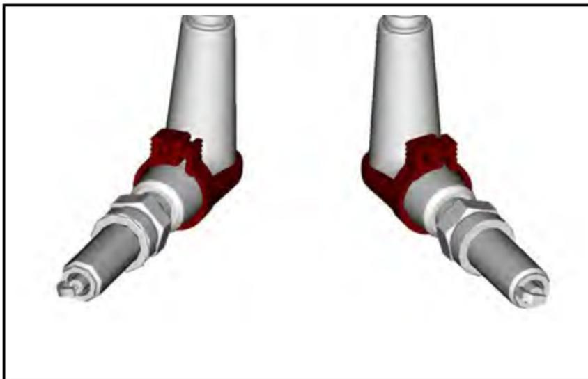
6. Снимите провода свечей зажигания, как показано.
