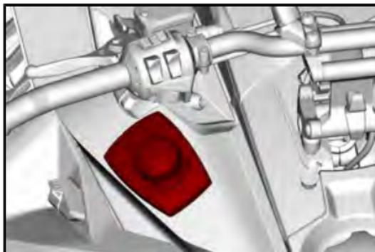
Er wird zum Navigieren durch die LCD-Anzeige und zur Steuerung des Audiosystems verwendet.
