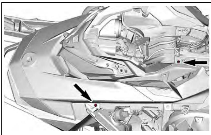
10. Lösen Sie die rückwärtigen Haken der oberen Karosseriebaugruppe aus den Schlitten in der Konsole.
