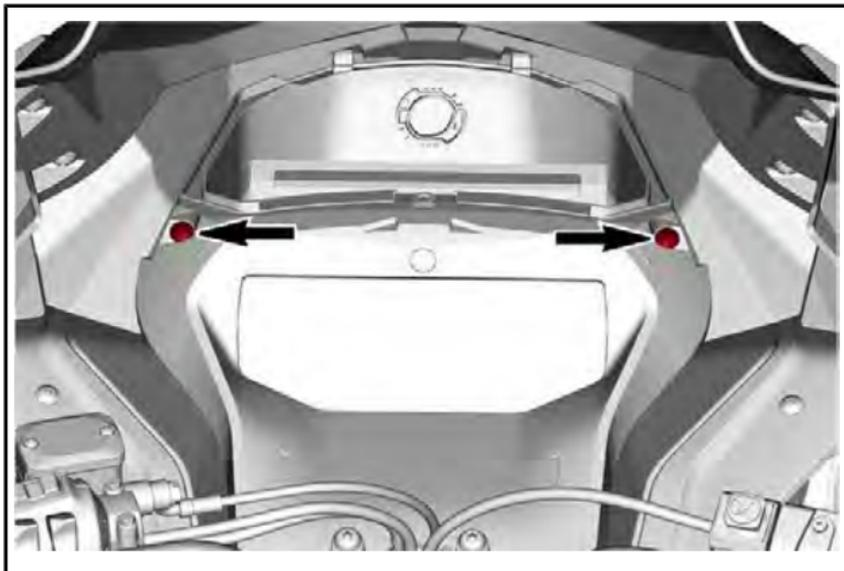
4. Heben Sie die Vorderseite der Anzeiginstrumenthalterung an und schieben Sie diese anschließend nach vorne, um sie abzunehmen.
