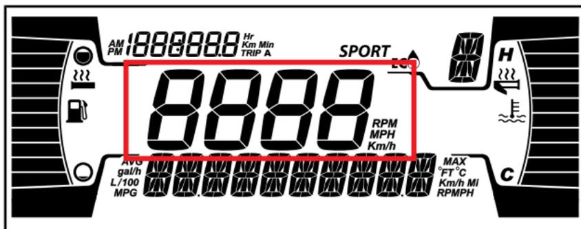
Zeigt die Drehzahl des Motors oder die Fahrzeuggeschwindigkeit in Km/h oder MPH an.
