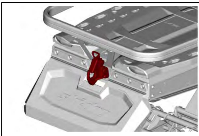
Drücken und drehen Sie den Griff, um die Abschlussplatte einzuziehen und den Haken zu öffnen.
