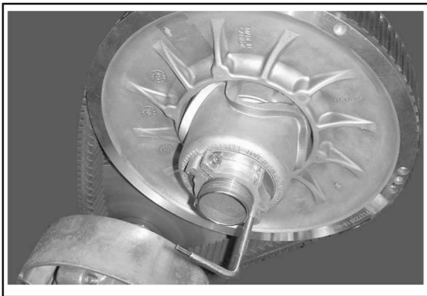
*TYPISCH - SCHEIBEN-EXPANDER AN NABE DER EINSTELLVORRICHTUNG MONTIERT*
