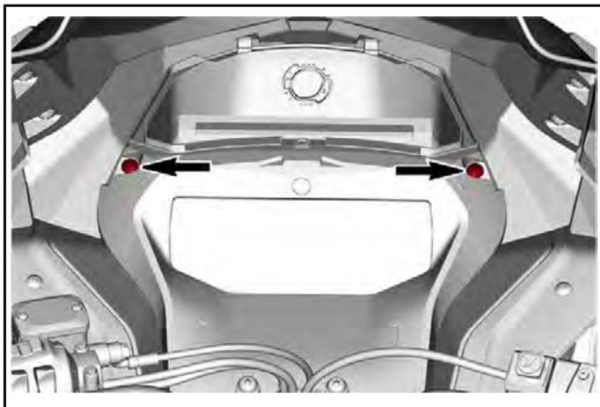
4. Heben Sie die Vorderseite der Anzeigeelementhalterung an und schieben Sie diese anschließend nach vorne, um sie abzunehmen.
