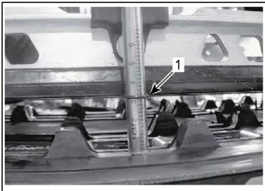
1. Durchbiegungs-O-Ring mit Gleitschuh ausgerichtet
