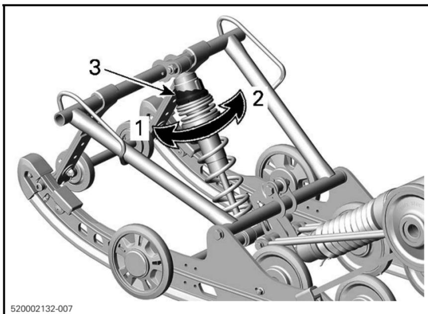
**CAM TYPE - HPG SHOCK ABSORBER**
