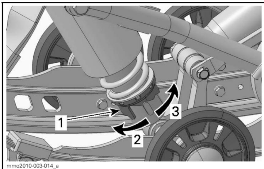
**CAM TYPE - MOTION CONTROL SHOCK ABSORBER**
