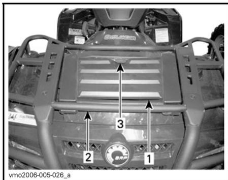
1. Pannello del vano anteriore per la manutenzione
