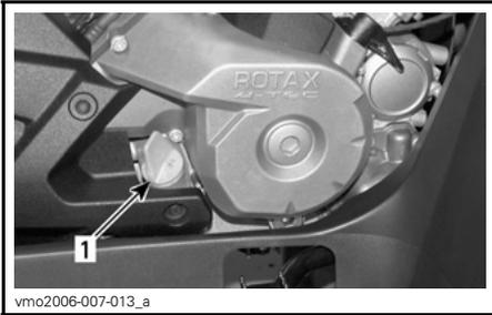
**LATO DESTRO DEL MOTORE****1. Astina di misurazione**
