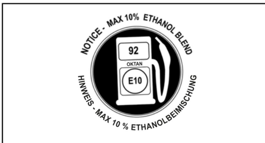
*AUF DEM KRAFTSTOFFTANKDECKEL – BEI MOTOREN DES TYPUS 600 ACE UND 900 ACE (IN LÄNDERN, IN DENEN RON-OKTANZAHLANGABEN VERWENDET WERDEN)*
