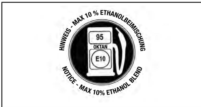
*AUF DEM KRAFTSTOFFTANKDECKEL - BEI TURBOMOTOREN (IN LÄNDERN, IN DENEN RON-OKTANZAHLANGABEN VERWENDET WERDEN)*
