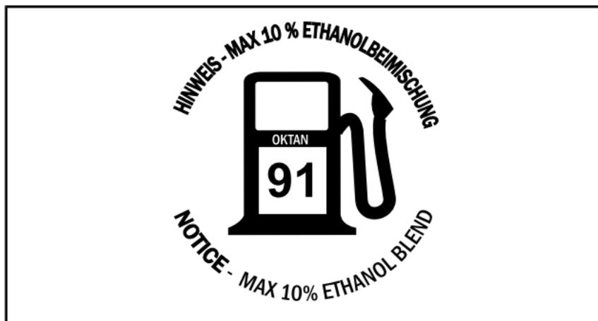
*AUF DEM KRAFTSTOFFTANKDECKEL - BEI TURBOMOTOREN
