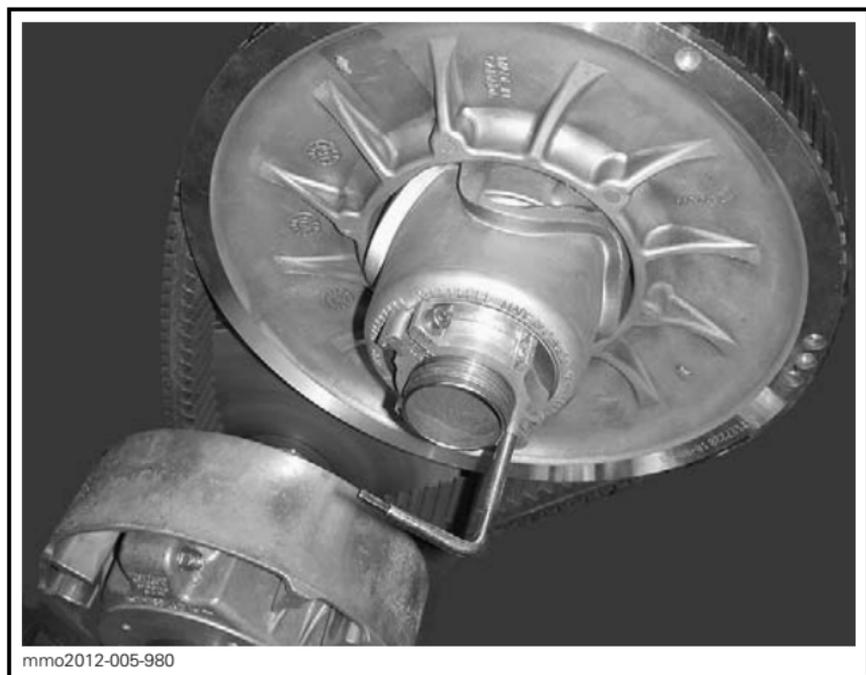
TYPICAL - PULLEY EXPANDER INSTALLED ON ADJUSTER HUB
