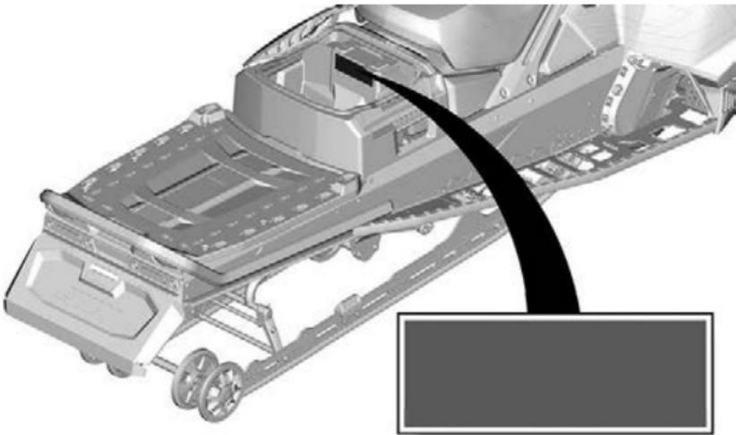
カーゴエリア - 警告ラベル ( 20および24 inトラック幅モデル )
