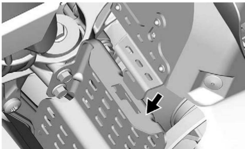
ドライブベルトガードをエンジンの方に押してから、車両の前部に向けて押します。
