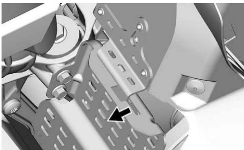
ベルトガードの後部をリテーナーの上にセットし、リテーニングピンを使用して固定します。
