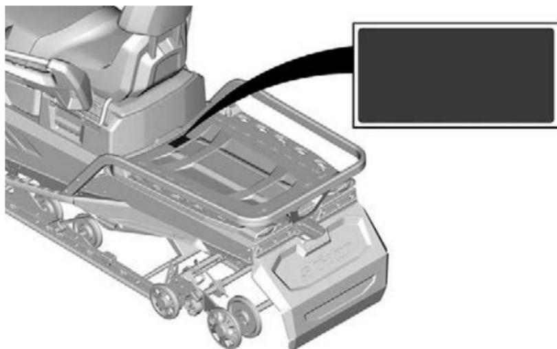
回転しているトラック - 警告ラベル (20および24 inトラック幅モデル)
