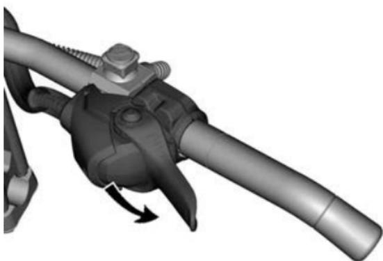
親指スロットル位置：下方方向に押すと、スロットルハウジングが回転する
