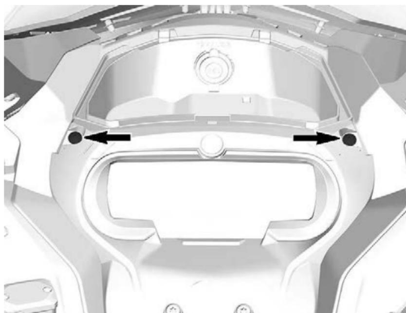
4. ゲージサポートの正面を上げ、前方にスライドさせて取り外します。
