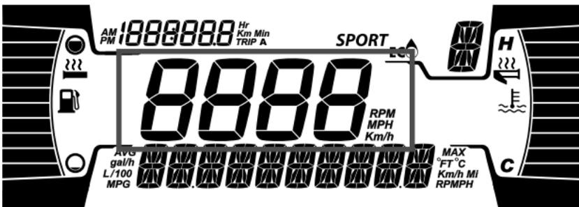
Indique le régime (tr/min) du moteur ou la vitesse (km/h ou mi/h) du véhicule.
