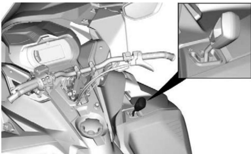
Utilisez ce levier pour sélectionner les vitesses. La boîte de vitesses comporte deux vitesses en marche avant et un point mort.
