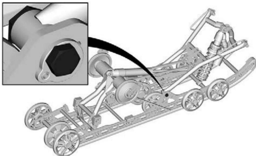
6. Entfernen Sie die Nocke, drehen Sie sie um 180° und bauen Sie sie wieder in die Schiene ein.
