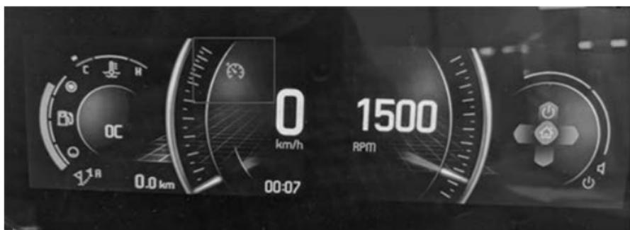
Wenn das Fahrzeug nicht innerhalb von 30 Sekunden startet, wird der Startmodus deaktiviert und die Motorleerlaufdrehzahl wieder normal.
