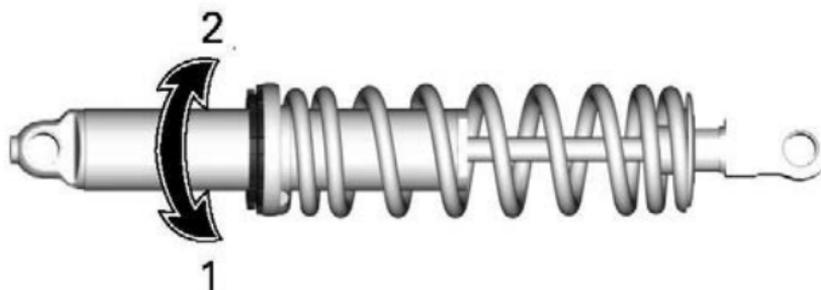
1. Vorspannung erhöhen
