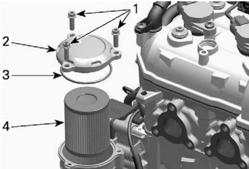
1. Schrauben der Ölfilterabdeckung
