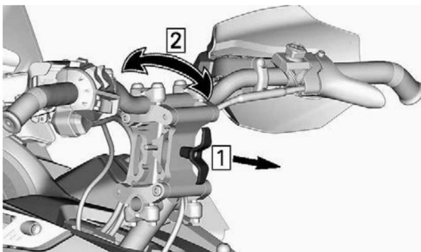
Den Lenker nach hinten und nach vorne bewegen, um sicherzugehen, dass der Mechanismus sicher eingerastet ist.
