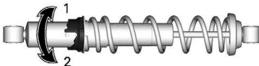
1. Vorspannung erhöhen
