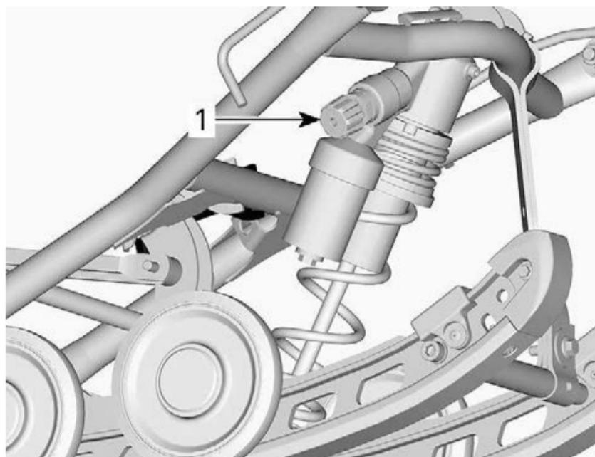
1. Einstellknopf für Kompressionsdämpfung des mittleren Stoßdämpfers
