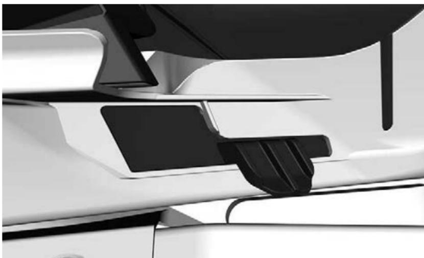
2. Abbassare l'estremità posteriore del modulo superiore della carrozzeria.
