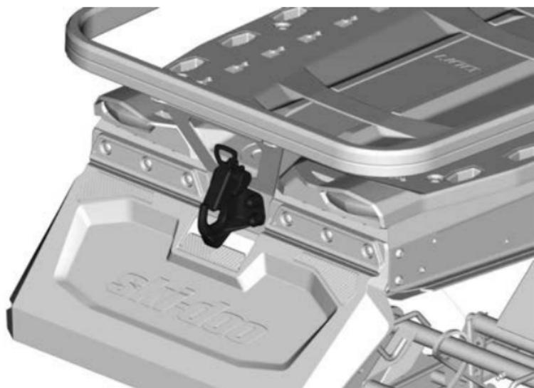
Per aprire il gancio, spingere e ruotare la maniglia per retrainere la piastra di bloccaggio.
