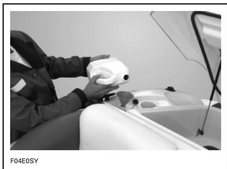
Verser de l'antigel jusqu'à ce qu'il coule dans le boyau de purge du tuyau d'échappement calibré.
