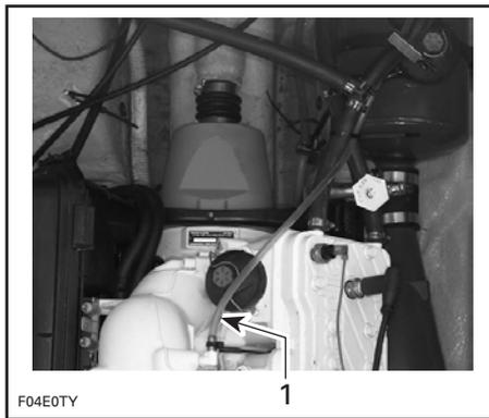
1. Verser de l'antigel jusqu'à ce qu'il coule dans le boyau de purge
