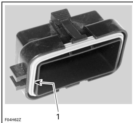
1. Placer convenablement le joint dans le couvercle
