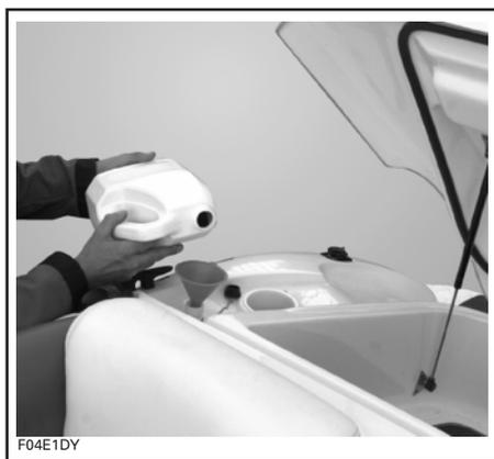
Verser l'antigel jusqu'à ce qu'il coule hors du boyau de purge du tuyau d'échappement calibré. Ce n'est qu'à ce moment que le circuit sera complètement rempli d'antigel.
