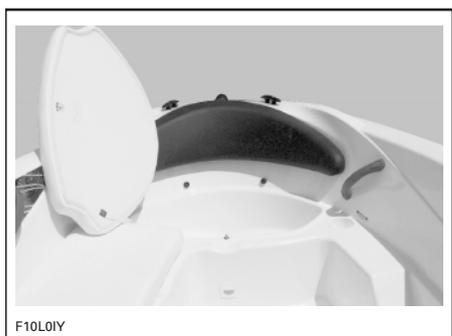
En réinstallant le siège, le faire glisser de façon que la base se trouve sous les deux butoirs, puis rabaisser le siège pour le verrouiller correctement.
