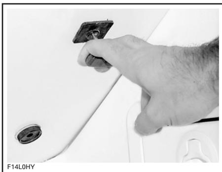
**TIRER SUR CE LEVIER POUR DÉVERROUILLER LE SIÈGE**
