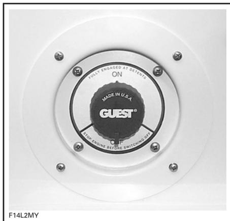
Lorsque l'interrupteur est placé à la position «OFF», TOUS les accessoires électriques et électroniques sont privés de courant et deviennent par le fait même inopérants.
