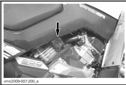
La finalidad del dispositivo de bloqueo es asegurar la palanca de cambio de marcha en la posición de punto muerto.
