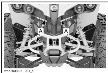
TÍPICO — AJUSTE DE PRECARGA — DELANTE
