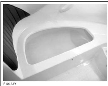
Pour réinstaller le siège, prendre soin de placer d'abord l'attache en «L», d'abaisser le siège, puis de le verrouiller.
