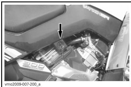
Obiettivo del blocco è fermare la leva del cambio in posizione di stazionamento.
