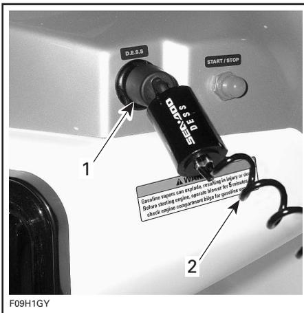
TYPICAL — IGNITION INTERRUPTER (STOP SWITCH) WITH LANYARD
