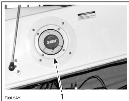
**TIPIQUE — INTERRUPTEUR COUPE-CIRCUIT PRINCIPAL DE LA BATTERIE**
