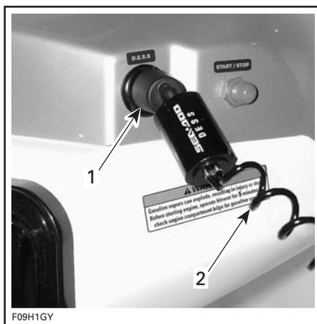
TYPIQUE — INTERRUPTEUR D'ARRÊT ET CORDON DE SÉCURITÉ
