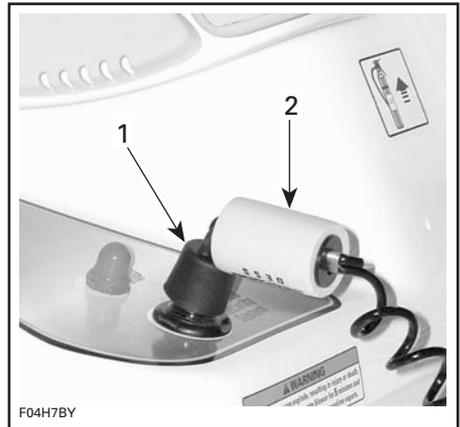
**TYPICAL — IGNITION INTERRUPTER (STOP SWITCH) WITH LANYARD**
