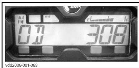
3. Carregue no botão do selector e NÃO SOLTE durante 2 segundos. Isto muda o modo visualizado para Velocidade, RPM ou Combinado.
