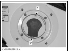
INTERRUPTOR DE DESCONEXIÓN DE LA BATERÍA PRINCIPAL
