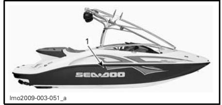
1. Emplacement du raccord de ventilation de réservoir de lest
