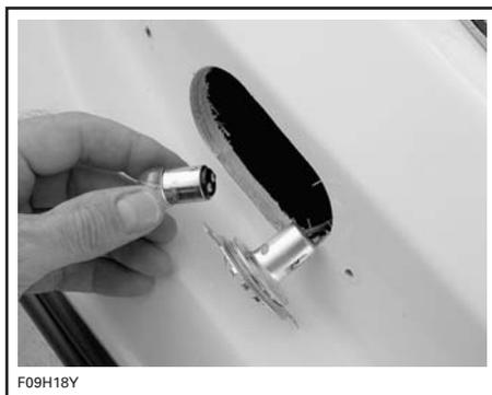
TYPIQUE — ENFONCER, TOURNER ET RETIRER L'AMPOULE
