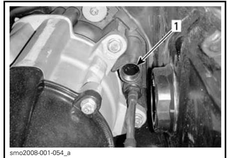
1. Raccord de rinçage — l'emplacement peut être différent
