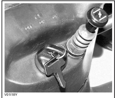
*CHOKE LEVER IN THE FULL CHOKE POSITION*
