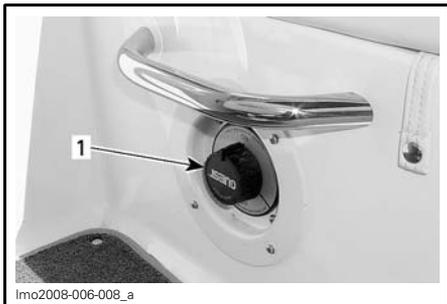
1. Interrupteur coupe-circuit principal de la batterie
