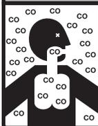
Le monoxyde de carbone (CO) peut causer des dommages cérébraux ou la mort. Les gaz d'échappement d'un moteur ou d'une génératrice contiennent du monoxyde de carbone, un gaz inodore et incolore.
