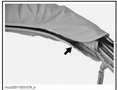
Posizionare le cinghie del Bimini top all'interno della copertura e chiudere lentamente la zip ripiegando le tende all'interno della copertura.
